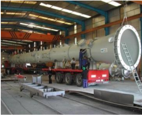
COLUMNA PETROX - REFINERIA TALCAHUANO CHILE
